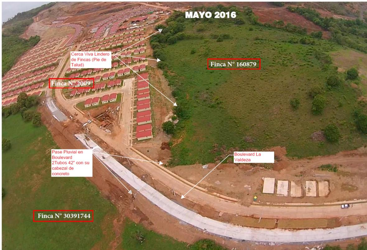
**C.1.3 FOTO N°3.** Esta foto fue tomada mediante un vuelo con *dron* durante la construcción de la Etapa II de Urb. La Valdeza en la Finca N° 2009 en Mayo del Año 2016 (cuando la Finca N° 160879 aún no pertenecía a Promotora La Valdeza S.A.), y muestra el Pase Pluvial de dos tubos de 42", su Cabezal de concreto construido en el Boulevard la Valdeza para permitir el flujo superficial de aguas pluviales desde la Finca N°160879 hacia la Finca N° 30391744.
