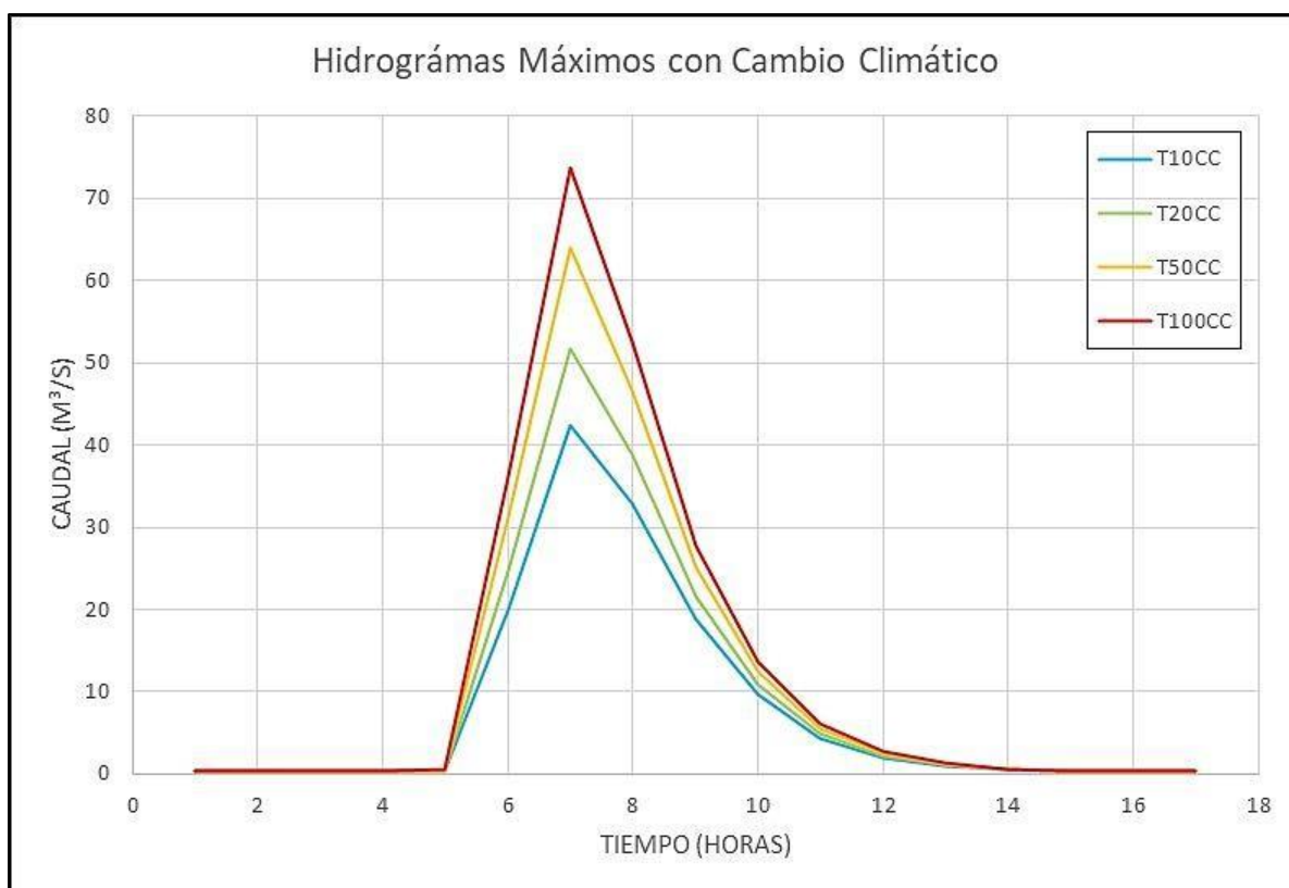
Ilustración 20: Hidrogramas generados a la salida de la cuenca para diferentes periodos de retorno incluyendo escenario de cambio climático.
