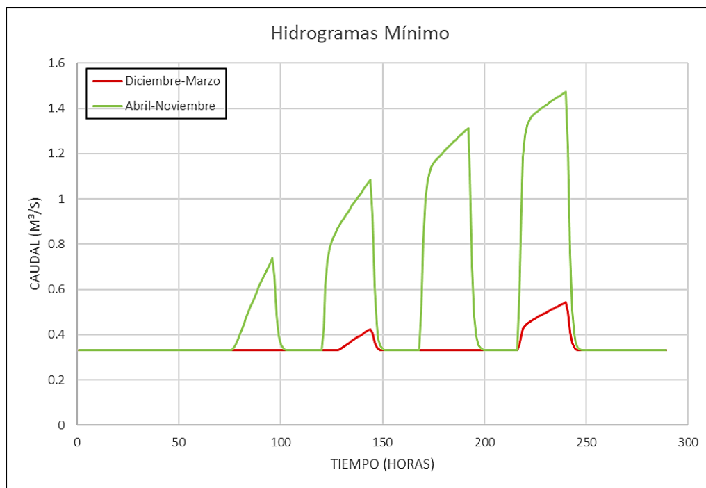
Ilustración 10: Hidrogramas mínimos generados a la salida de la cuenca para los diferentes meses.
