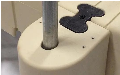
Foto N° 9. Este soporte de polietileno de uso estándar proporciona un amplio anclaje para los muelles más pequeños en condiciones moderadas.
