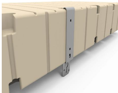
Foto N° 11. Este soporte está diseñado para el anclaje ligero con cadena y/o para fijar postes de barandilla o de amarre
