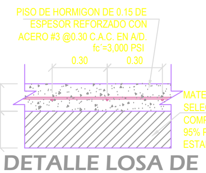
DETALLE LOSA DE PISO ESC. 1/20
