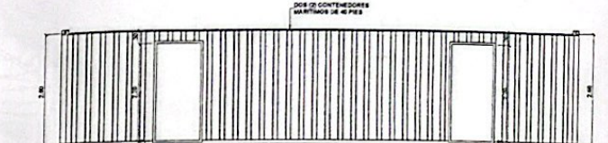
ELEVACION PRINCIPAL MODULO DE BAÑOS ESCALA 1:50
