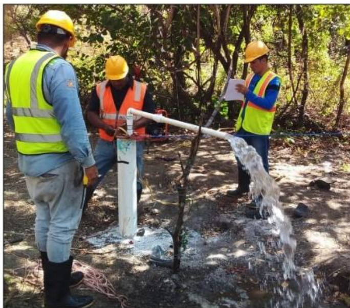
Figura 16. Realización de la prueba de bombeo en el Pozo 1-23. Fuente: Equipo Consultor, 2023.
