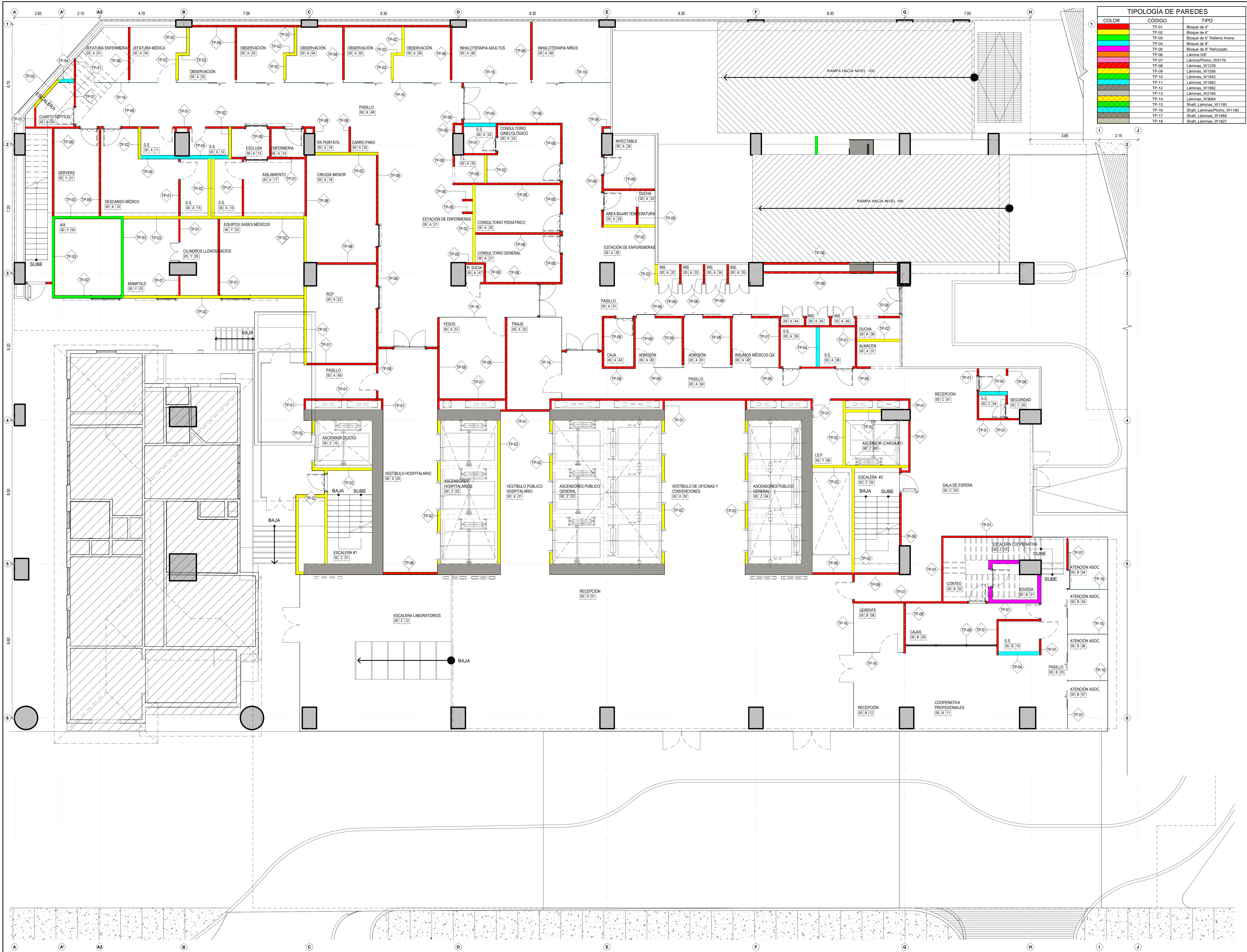
1 TIPOLOGÍA DE PARED N. +000 - PLANTA BAJA 1:75
