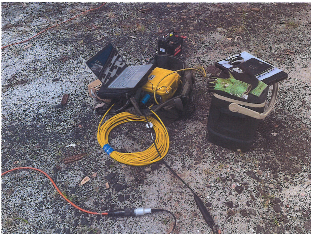
Fotografía Nº 2.2.1: Sismógrafo GEODE 24-Channel SEISMODULE (Geometrics, Inc.)
