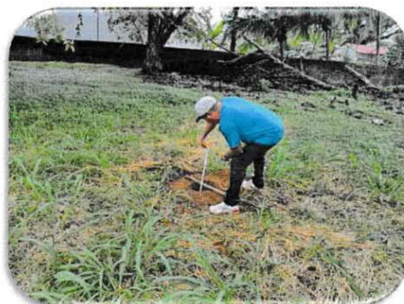
Foto 4: Medición del descenso del agua en el hoyo 2, Octubre, 2,023.
