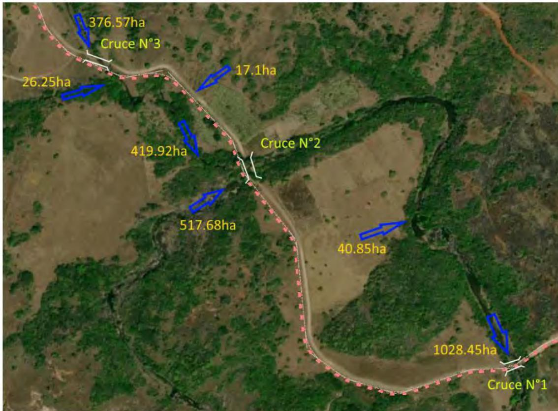
Ilustración 16: Área de microcuencas en zona de trabajos y diseño geométrico vial.
