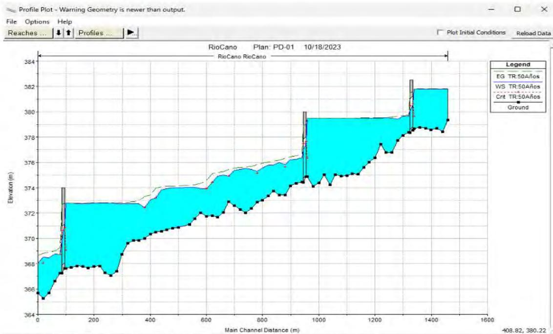
Ilustración 34: Perfil sobre el centro del Río Caño, Condición Futura.
