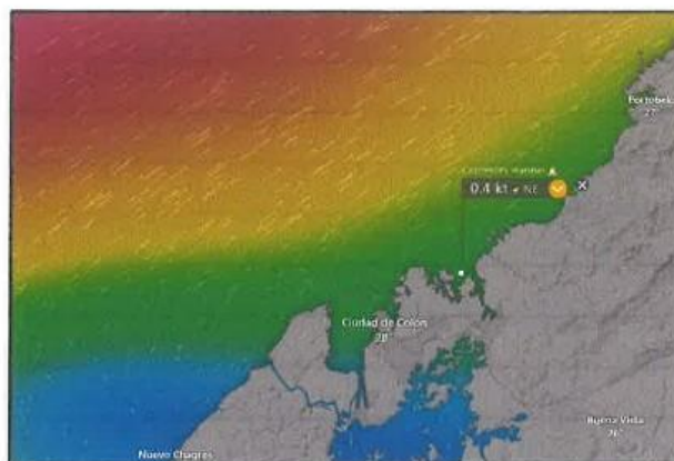
Figura N° 15. Magnitud de las corrientes marinas en la boca de Bahía Las Minas. Como se aprecia la magnitud de la corriente es de 0.4 kt, y hemos tomado nota de hasta 0.7 kt. Tomado de Windy el viernes 6/10/2023 /9/.
