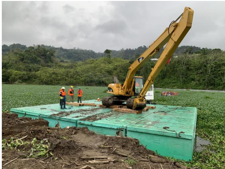
Figura 7. Tipo de excavadora y barcaza a utilizar
