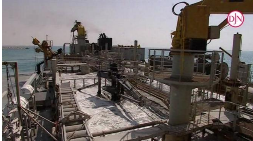
Figura 5. La tolva o bodega de carga de la TSHD (izquierda) contiene el material dragado
