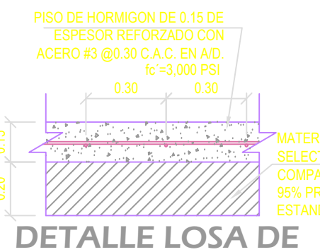
DETALLE LOSA DE PISO ESC. 1/20
