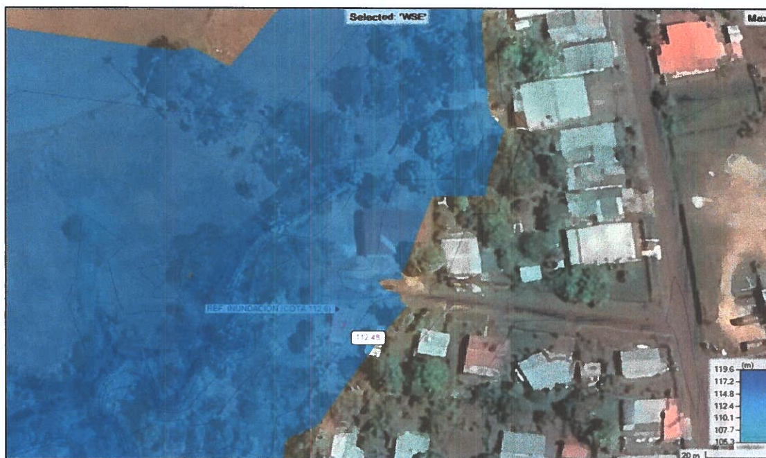
Fig.19. Nivel de Crecida Máxima, registrado con nivel del piso de una residencia en el sector de Santa Marta (112.60) vs NAME calculado (112.49).
