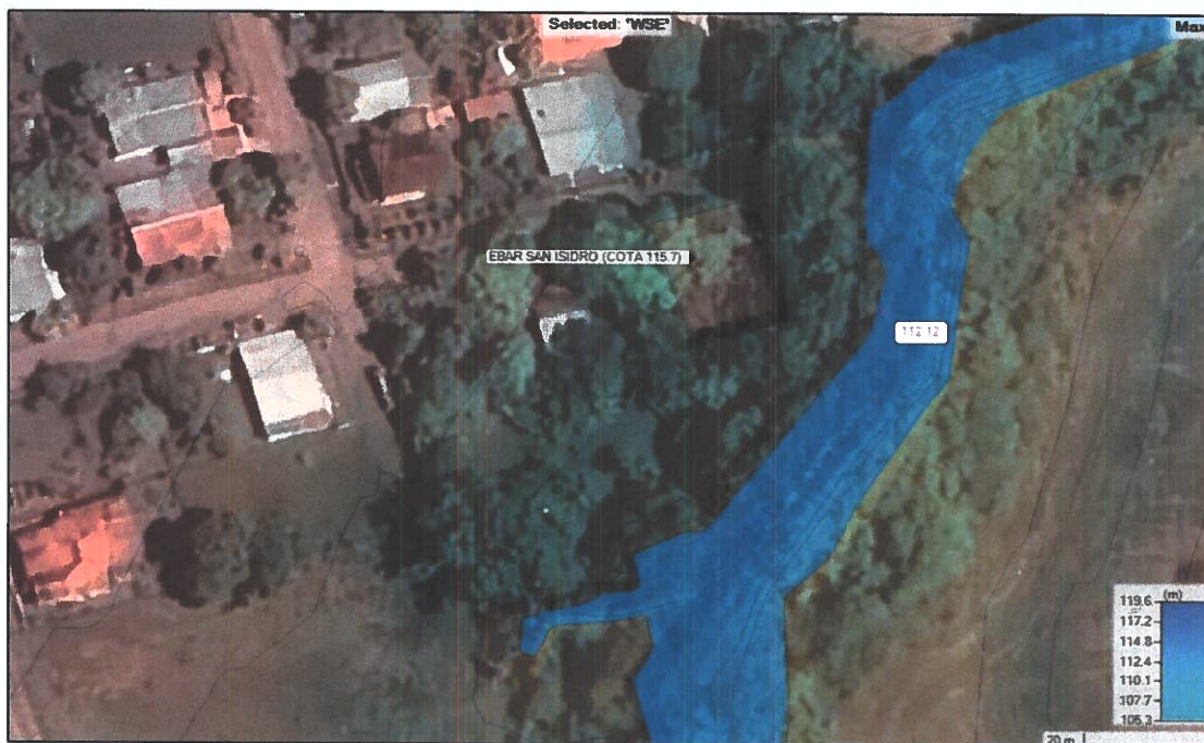
Fig.18. Nivel de Terracería de la EBAR San Isidro (115.70) vs NAME (112.12).
