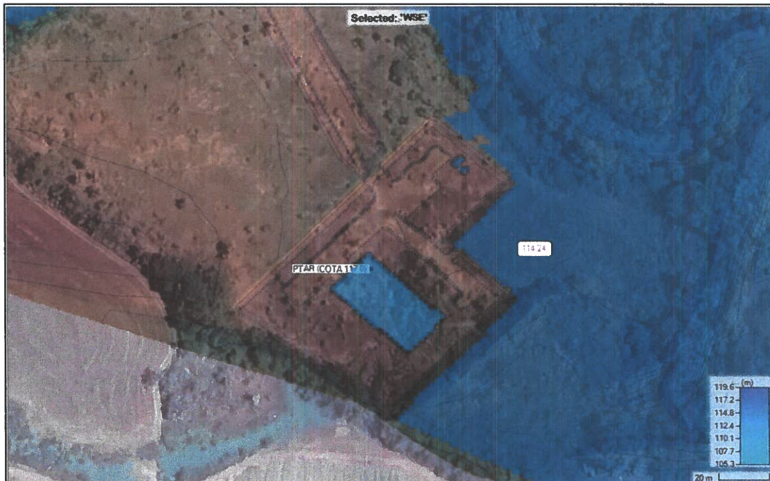
Fig.13. Nivel de Terracería de la PTAR y EBAR de Vía Los Llanos (117.0) vs NAME (114.24).
