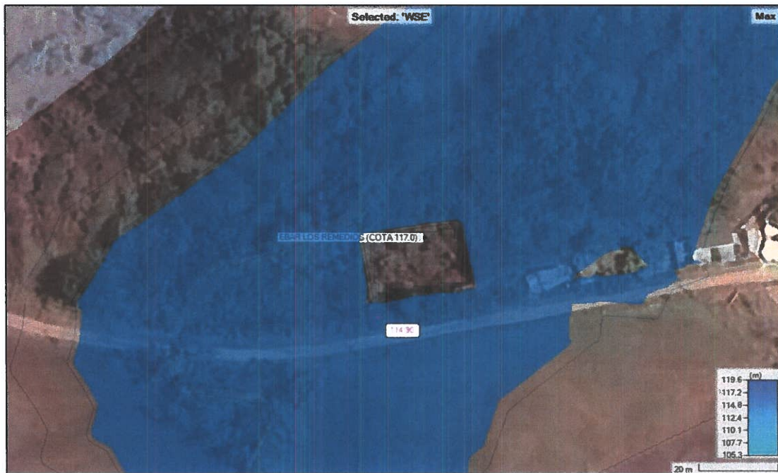
Fig.15. Nivel de Terracería de la EBAR Vía Los Remedios (117.0) vs NAME (114.90).
