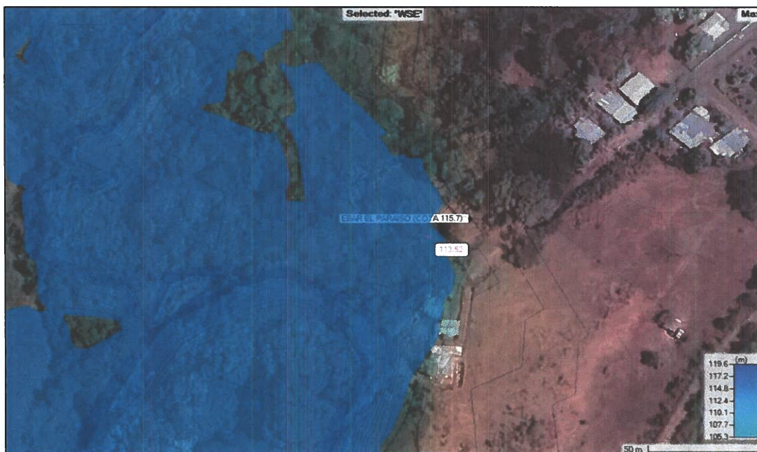
Fig.16. Nivel de Terracería de la EBAR El Paraíso (115.70) vs NAME (113.52).
