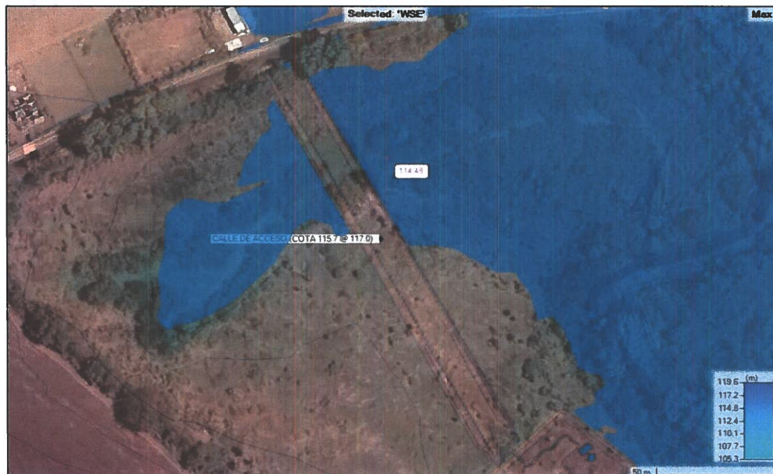
Fig.14. Nivel de Terracería de la Calle de Acceso a PTAR (115.20 @ 117.0) vs NAME (114.49).
