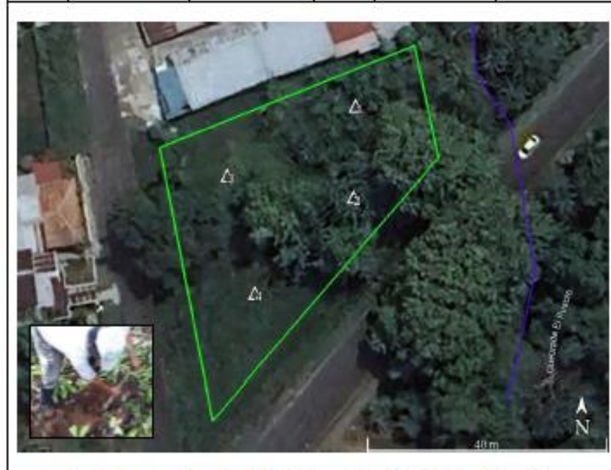
Area de proyecto vista en Google Earth y los sondeos efectuados y georreferenciados con sus respectivas coordenadas en el Sistema Geodésico Mundial (WGS 84).
