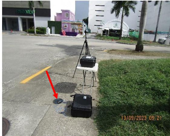
Imagen 14.10.1. Equipo utilizado para medir vibraciones
