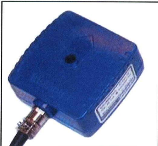
Los transductores se deben colocar en dirección a la fuente de vibración.
