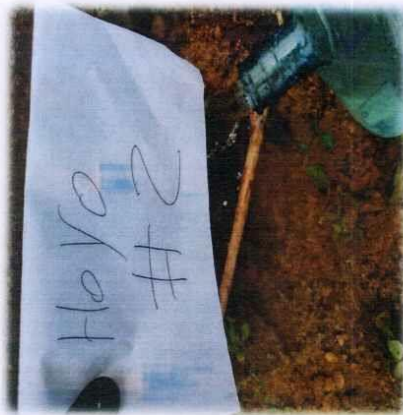
Foto 3: medición de descenso del agua en el hoyo 2. 15 de Abril 2,023.
