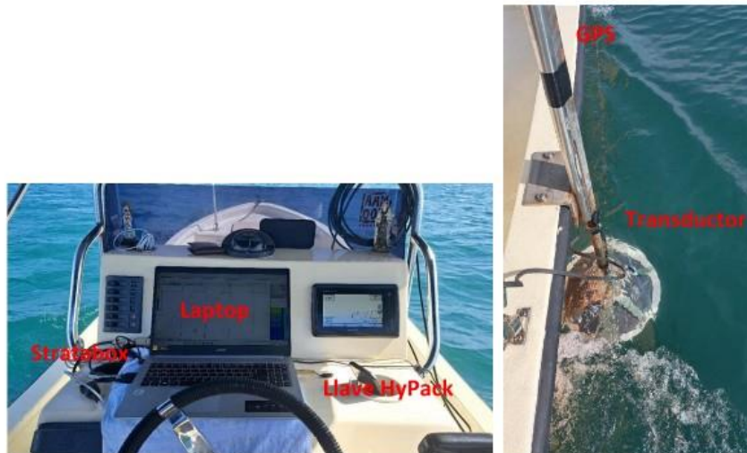
Ejemplo de Instalación de los equipos en la embarcación
