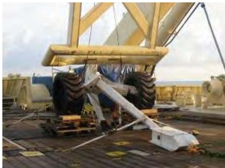
Figura 3: Rezón de perforación con ruedas
