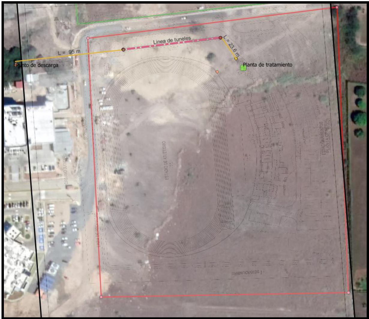
Figura #1. Vista del alineamiento desde la planta de tratamiento hacia el medio filtrante y posteriormente hacia el punto de respaldo de descarga.
