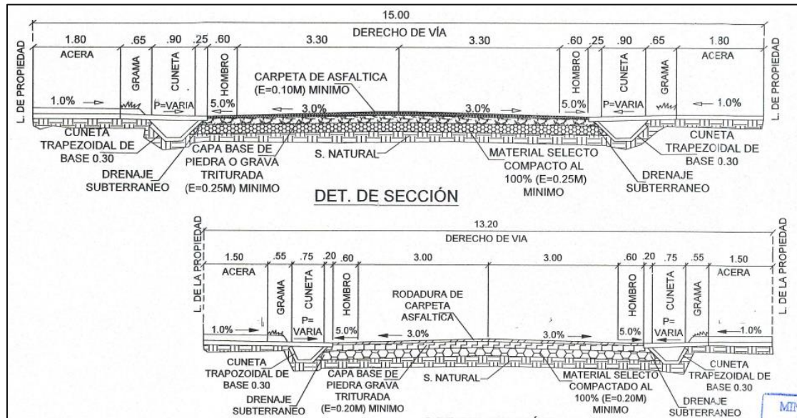
Ilustración 3. Vista de plano con especificaciones técnicas de las cunetas y vías de acceso
