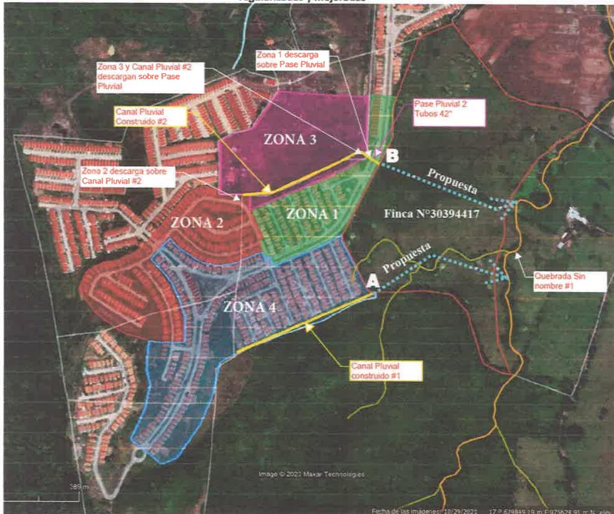
Foto N°5 – Vista de la Descarga del Canal Pluvial #1 sobre la Finca N°30394417 (PUNTO A)
