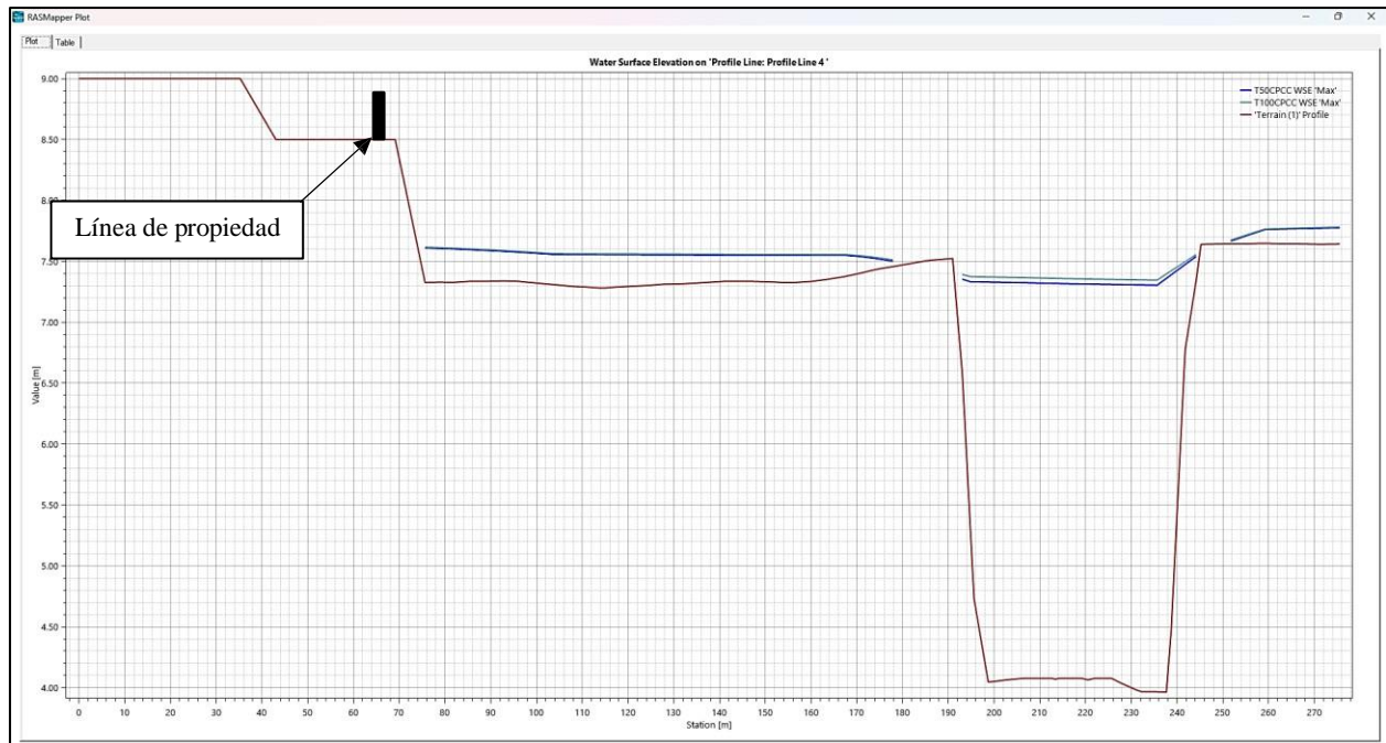
Ilustración 30: Cuatro secciones transversales del río Cabra en la zona colindante con el proyecto con mayor potencial de inundación. Color rojo es el terreno natural, azul es nivel de agua en condición con proyecto y cambio climático para un periodo de retorno de 50 años y verde con proyecto y cambio climático para un periodo de retorno de 100 años.
