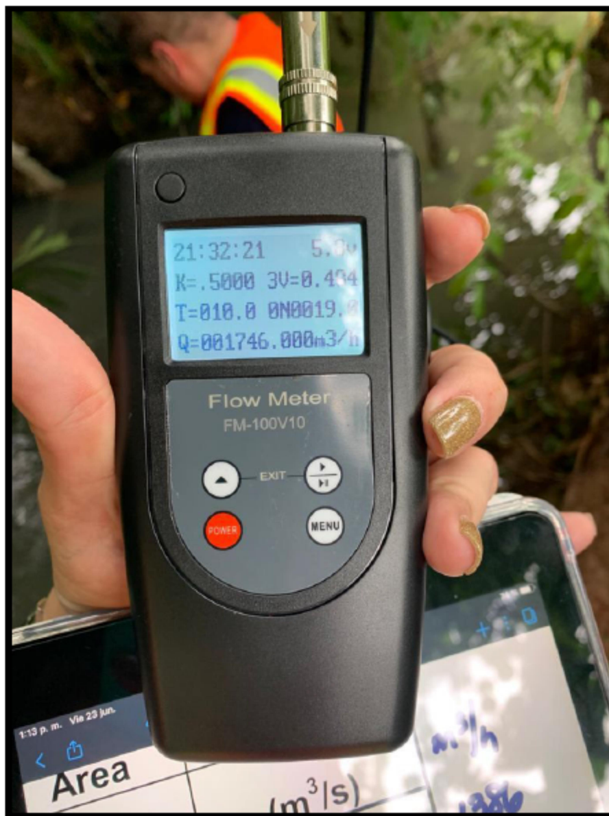
Figura 18 - Equipo utilizado para la caudalimetría
