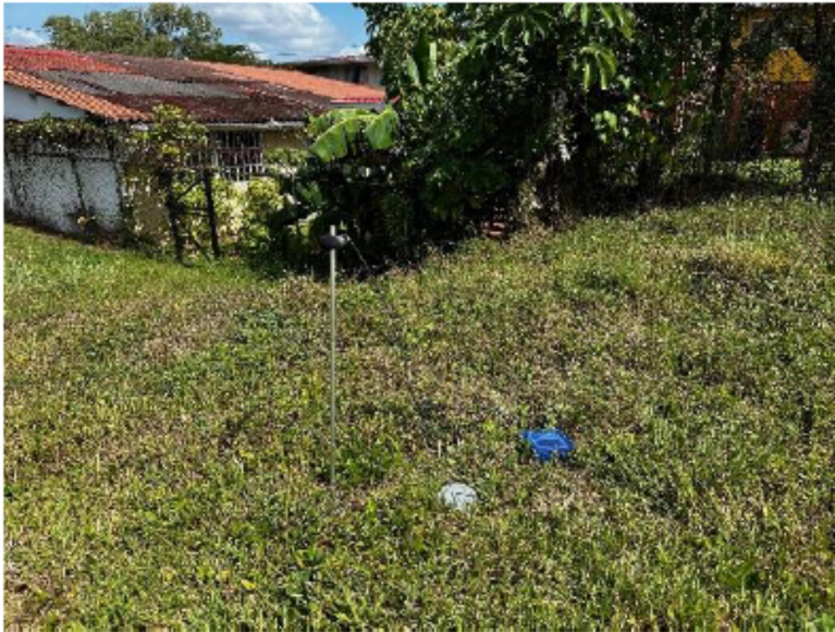
Fotografía 13 Medición de vibraciones en el suelo con Sismógrafo Instantel Micromate
