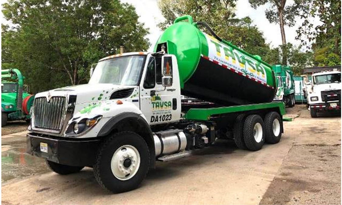
Fotografía 29 Camión Váctor para succión de líquidos de sistemas sanitarios
