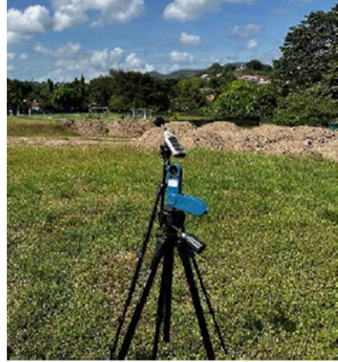
Fotografía 12 Medición de ruido ambiental con sonómetro integrador
