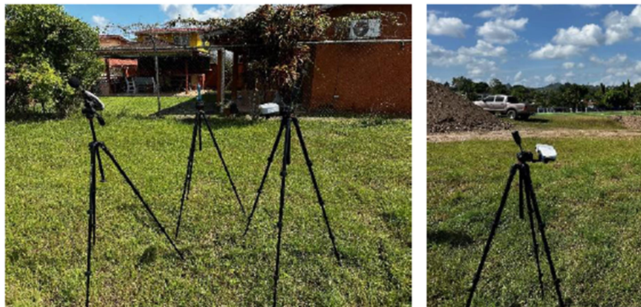
Fotografía 11 Medición de calidad de aire ( PM_{10} )
