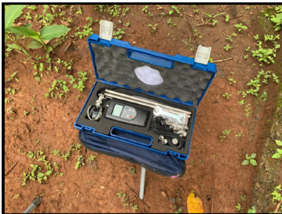
Figura 17 - Equipo utilizado para la caudalimetría
