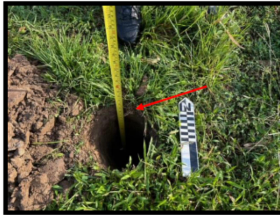
Fotografías 19 y 20. Zona evaluada en el sector donde se instalará en Tanque de Tratamiento de Aguas Residuales. Nótese en el perfil norte del sondeo evidencia de cemento
