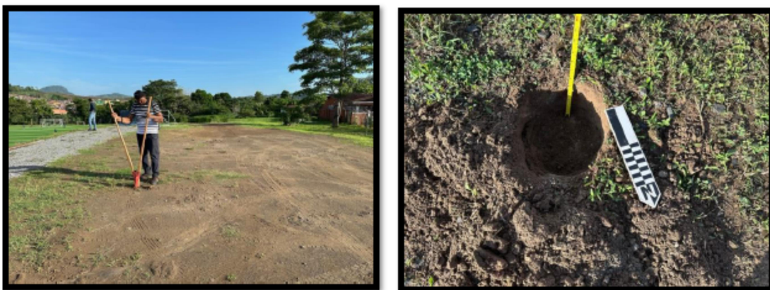
Fotografías 3 y 4. Proceso de confección de los sondeos y muestra de los sondeos. Nótese que se trata de un área alterada con sondeos pocos profundos
