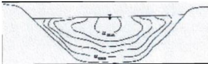
Fig. 4.2 Distribuciones típicas de la velocidad en un canal abierto
