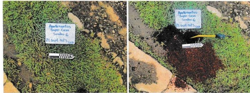
Imagen 19 y 20.- Inicio de sondeo 6 (derecha). Fin de sondeo 6 (izquierda)
