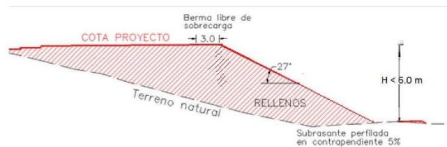
Figura 8 Esquema conformación de rellenos hasta de 6.0 m de espesor
