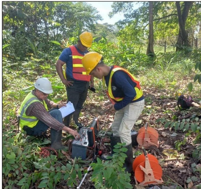
Figura 10. Captura de datos en el SEV-3. Fuente: Equipo Consultor, 2022.
