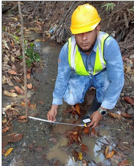
Figura 13. Medición de características físicas básicas del flujo, cauce punto No. 2 Fuente: Equipo Consultor (14/02/2023).
