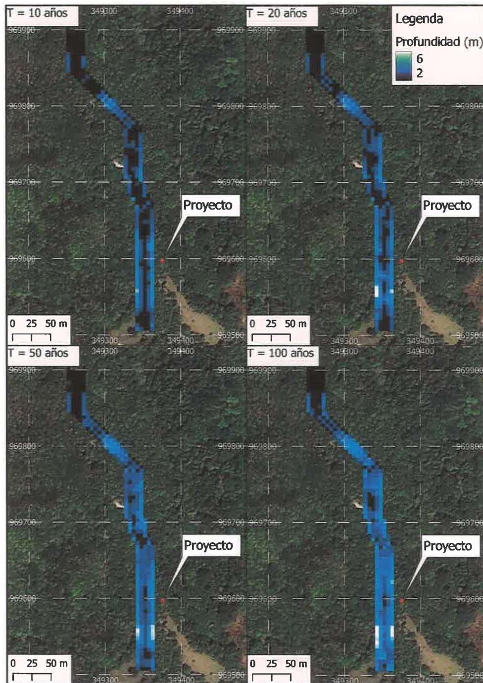
Ilustración 21: Mapas de escorrentía con profundidades máximas generadas en el modelo hidráulico de HEC-RAS en función de la profundidad del agua incluyendo escenario de cambio climático.
