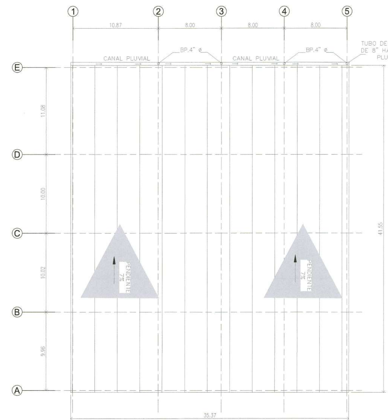
PLANTA DE CUBIERTA N+16.36
