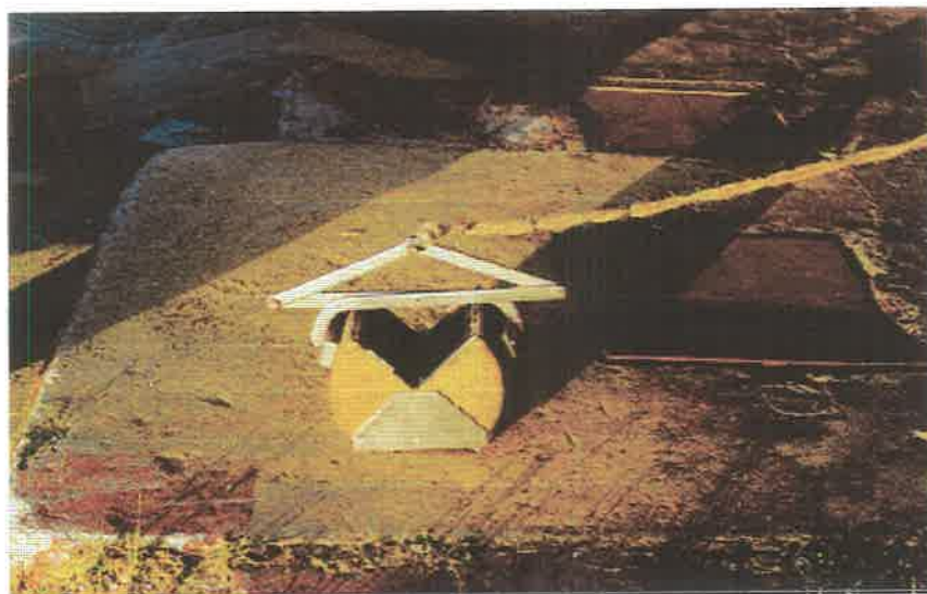
Foto 1.2. Draga de Petersen que permite la toma de sedimentos marinos.
