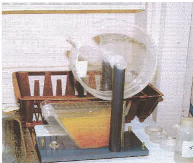
Foto 1.8. Fraccionador de Folsom, utilizado para extraer alicuotas de zooplancton.
