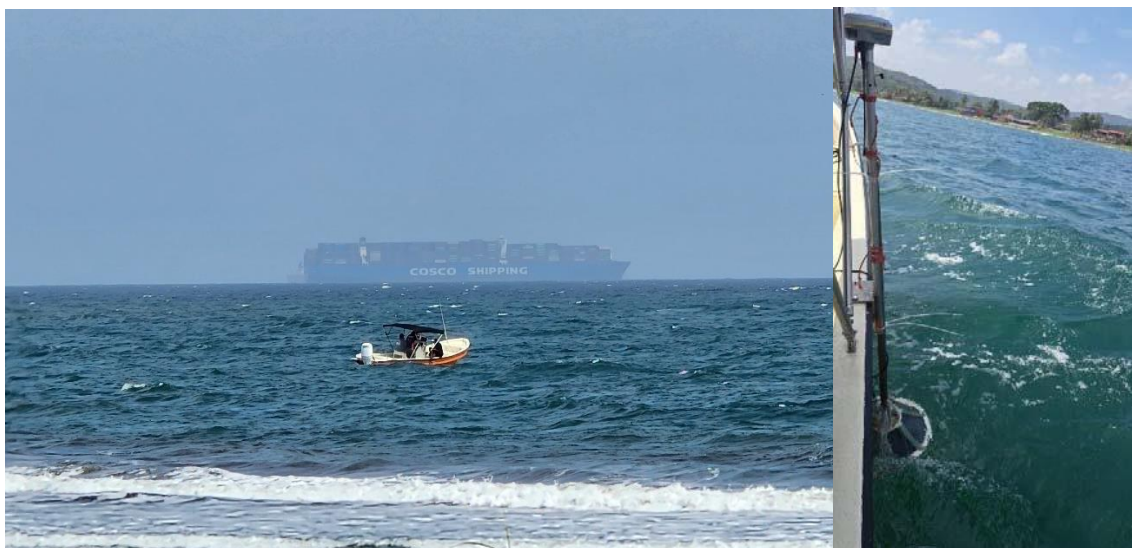
Fig. 9.- Trabajo de campo para la prospección batimétrica: a la izquierda, vista desde la playa del proceso (desde el punto identificado como 211 en la Fig. 10, ver también Fig. 7) y a la derecha vista desde el bote, con los sensores remotos sobre la borda, mirando hacia el mismo punto.
