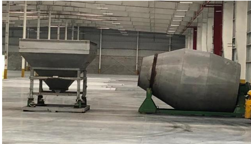
Foto No. 1 Imágenes reales de la tolva de pesaje (izquierda) y mezclador rotativo (derecha)
