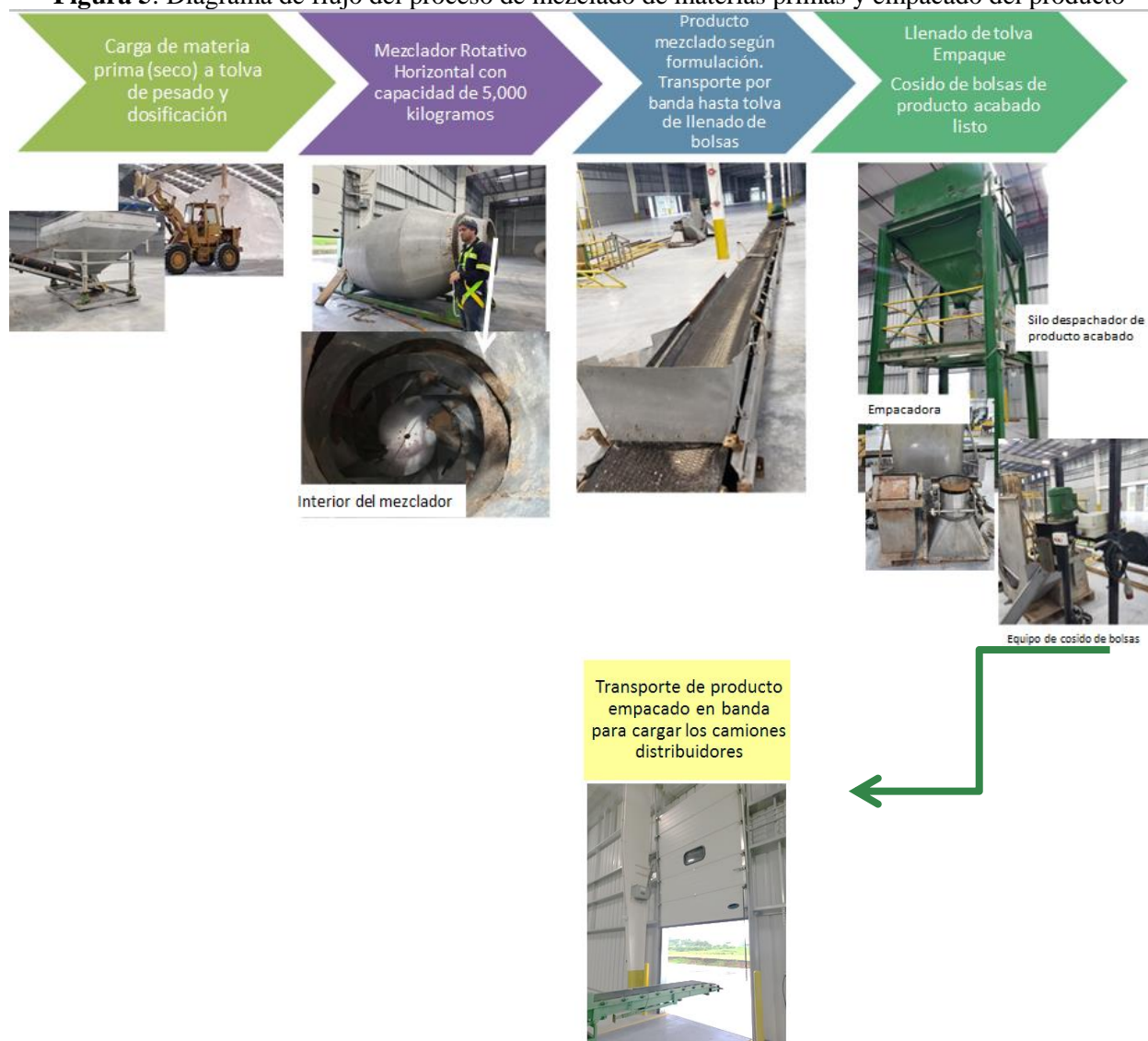
Figura 5: Diagrama de flujo del proceso de mezclado de materias primas y empaque del producto
