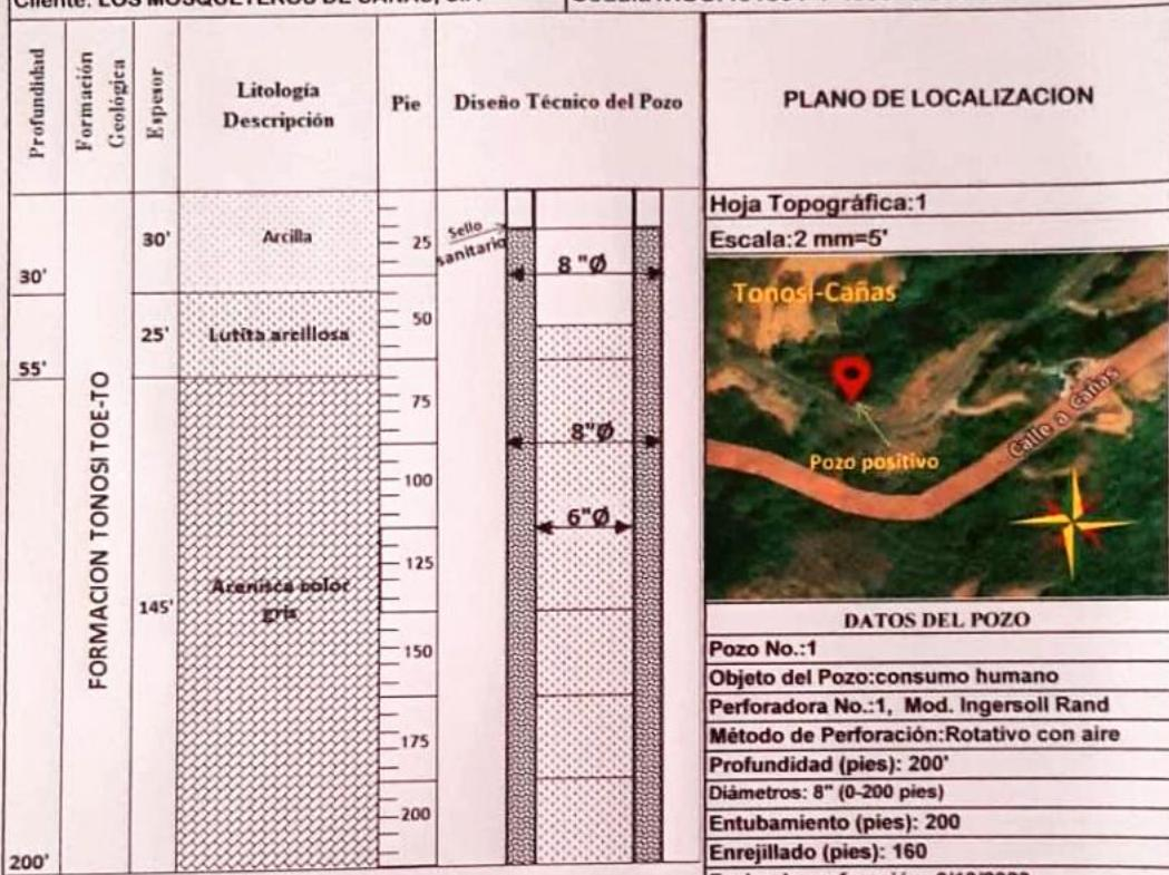
Observación: Se realizó una perforación de 200' pies de profundidad, con el método rotativo con aire, con diámetro de 8" (0-200 pies), entubamiento de 200 pies de PVC de 6 pulg. de diámetro, calibre 40, 40 pies con tubería ciega, 160 pies con tubería ranurada, engravillado (de 3/8") hasta los 200' pies. Se encontró dos fuentes de agua significativa a los 48 y 164 pies de profundidad, 10 pies de sello sanitario, empacado con grava como filtro.
