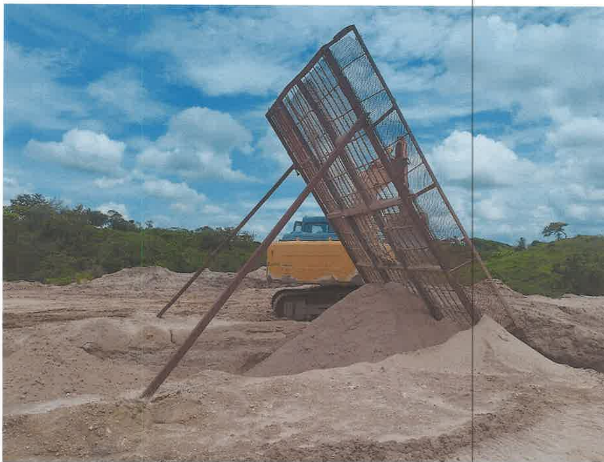
Foto 2: Operación de limpieza de arena mecánica con arnero de malla metálica en la operación previa.
