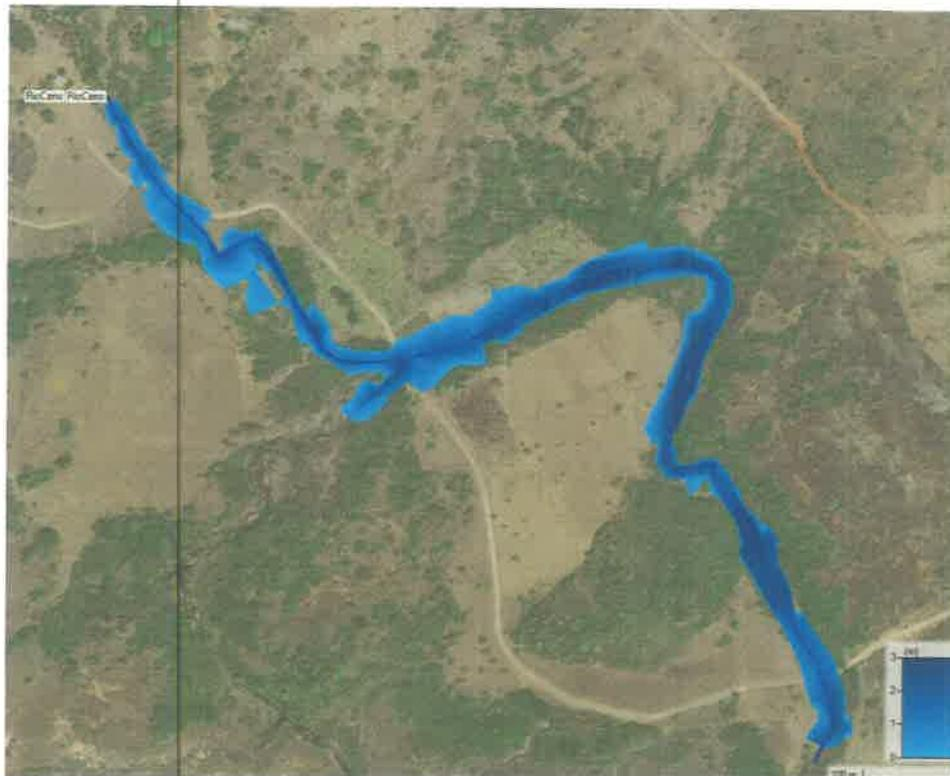
Ilustración 25: Llanura de Inundación o Altura de aguas, Condición Actual.
