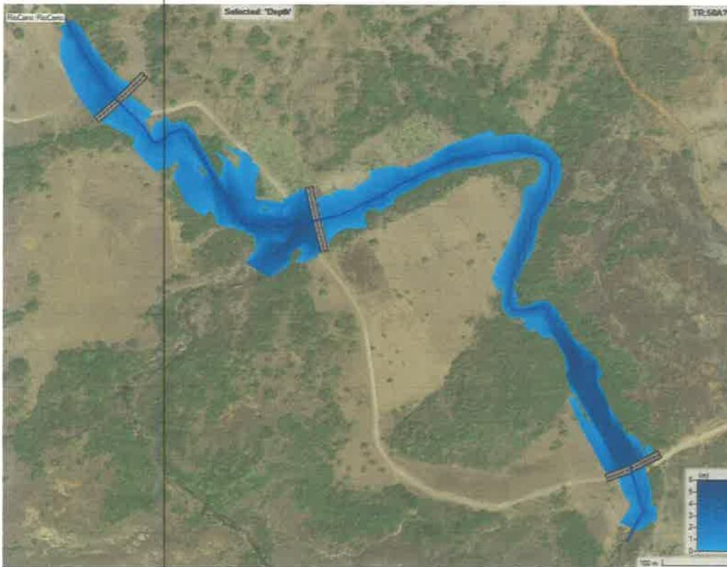
Ilustración 35: Llanura de Inundación o Altura de aguas, Condición Futura.
