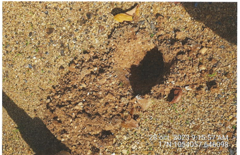
Foto 7, 8, 9 y 10: sondeos realizados a una profundidad de 50cm, con material pétreo, tierra intervenida por rellenos realizados anteriormente.
