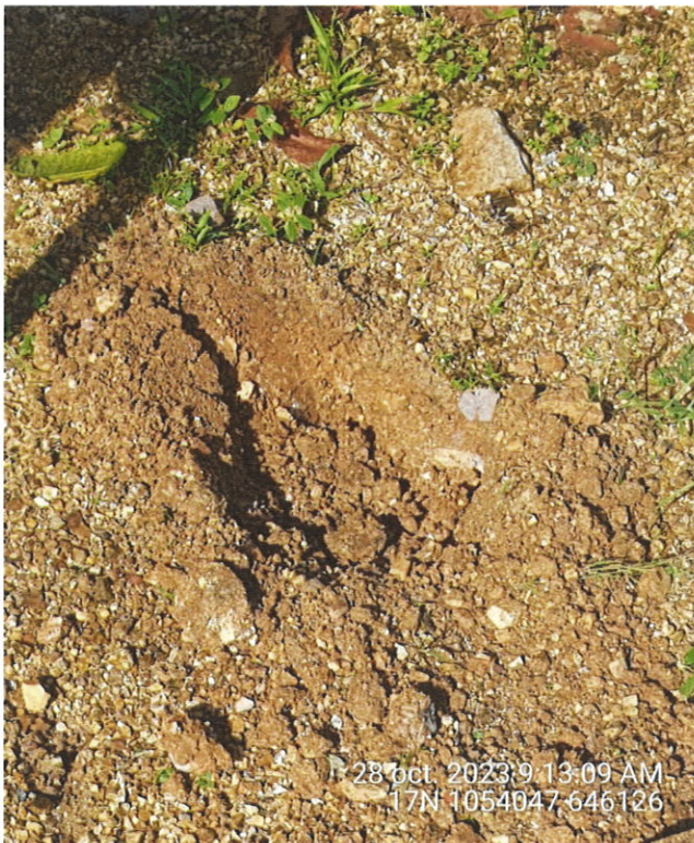
Foto 7, 8, 9 y 10: sondeos realizados a una profundidad de 50cm, con material pétreo, tierra intervenida por rellenos realizados anteriormente.
