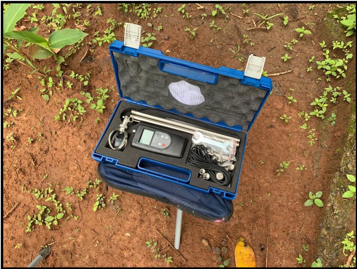
Figura 17 - Equipo utilizado para la caudalimetría
