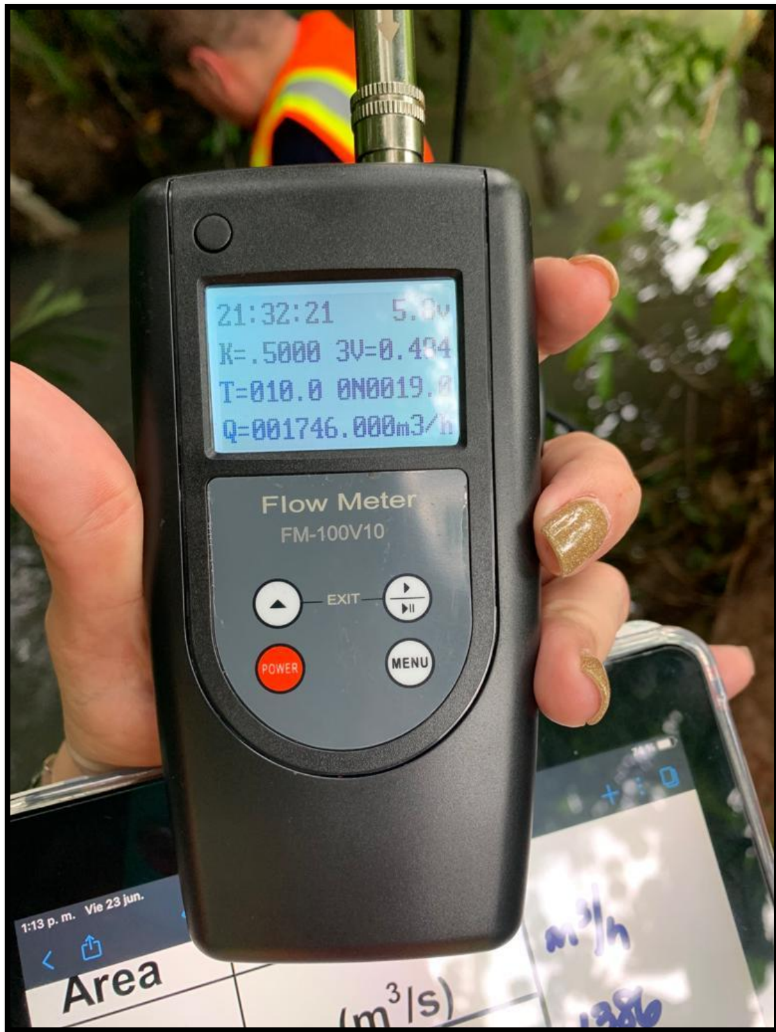
Figura 18 - Equipo utilizado para la caudalimetría
