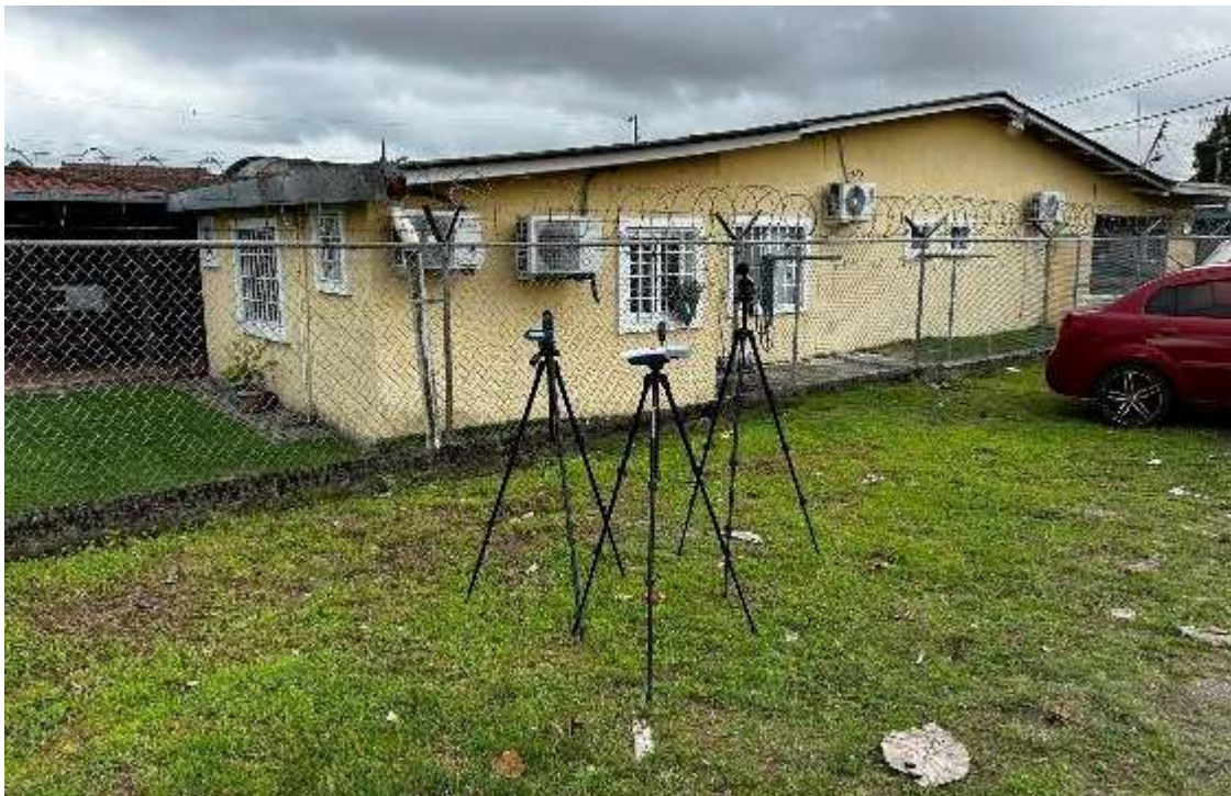
Foto 11 Medición de ruido ambiental con sonómetro integrador
