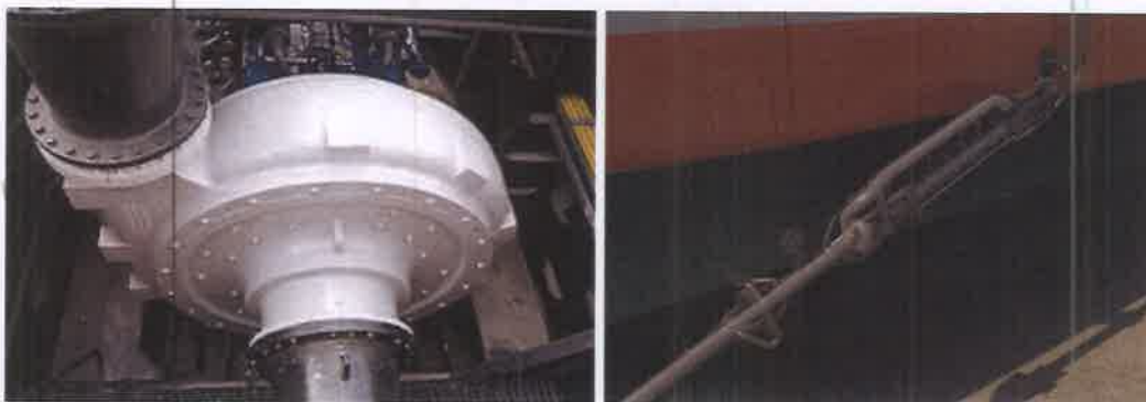
Figura 4: Una bomba de dragado interior (izquierda) o una bomba sumergida exterior (derecha) o ambos sistemas combinados extraen la mezcla de suelo y agua hacia arriba del fondo marino a través del tubo de succión a la tolva o bodega del buque
