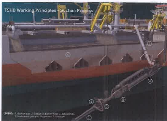
Figura 3. El tubo de succión (1) con sus partes: cardán (2), manguera de succión (3), tubería de agua de chorro (4) y bomba sumergida (5).
