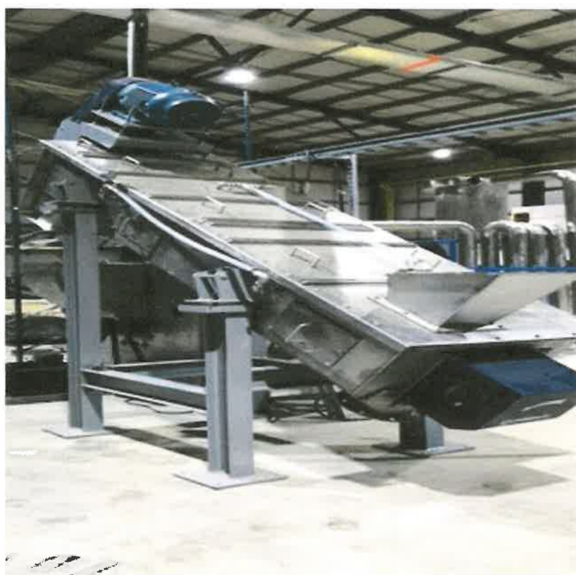
Ilustración: Lavadora de fricción 50/300, Rotor inox, 30 hp, 440 v. Fuente propia.
