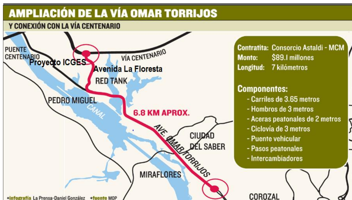
Figura No 5.15 Croquis de el plan vial de ampliación de La Vía Omar Torrijos en ejecución que conectará a la Vía Centenario lo que permitirá mayor fluidez del tráfico, y beneficiará a los residentes de la Ciudad del Saber y Clayton (Fuente: La Prensa.com)
