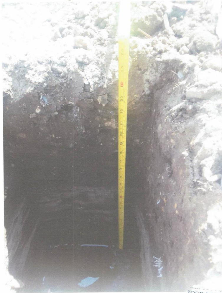
MEDICION DEL DESCENSO DEL AGUA
