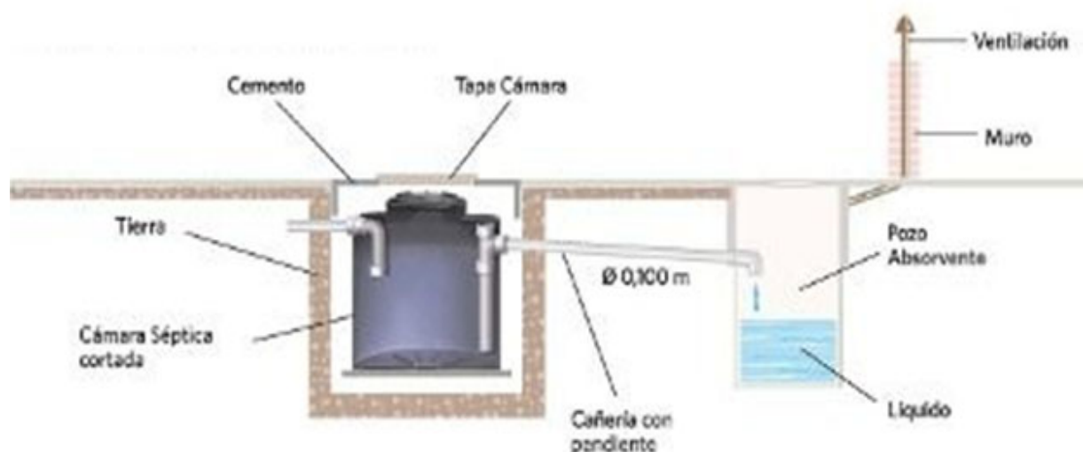
Ilustración 6. Detalle Típico del Sistema de Tanque Séptico
