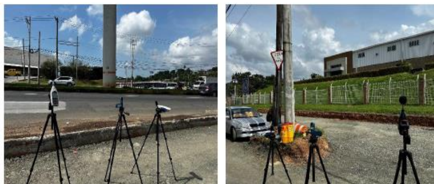
Figura 18. Equipo utilizado para las mediciones de ruido y calidad de aire
