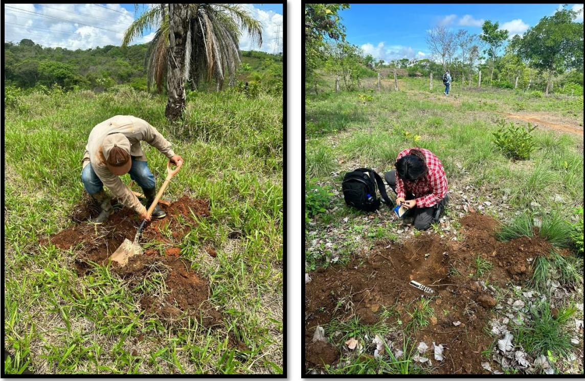
*Fotografías 6 y 7. Realización de sondeos y revisión de tierra y coloración del suelo registrado.*
