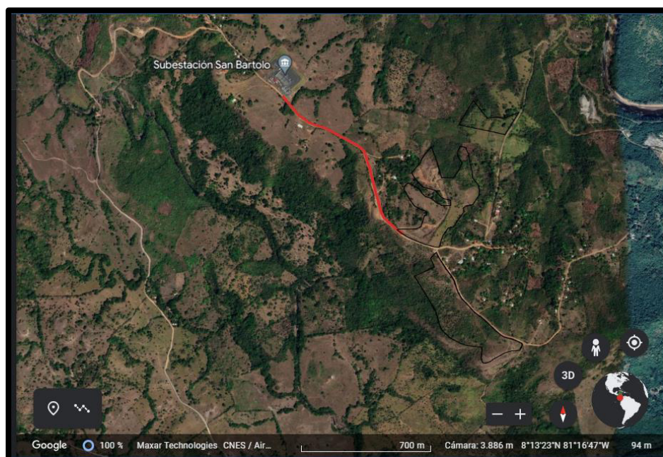
Mapa 4. En rojo es posible observar la Línea Aérea de Evacuación de la planta que se conectará a la Subestación Eléctrica de San Bartolo 230/115/34 kV, en correlación con la distribución del área en los 3 globos evaluados.
