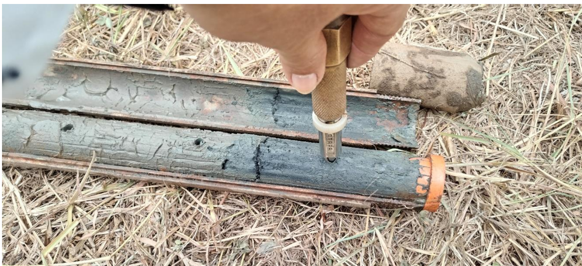
FOTO No 8: ENSAYO DE RESISTENCIA A LA COMPRESIÓN CON EL PENETRÓMETRO DE BOLSILLO.
