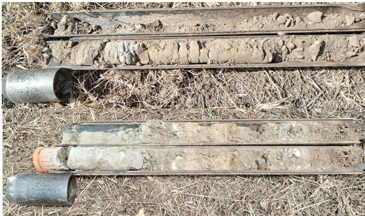
FOTO No 6: MUESTRAS DEL RELLENO EXTRAÍDAS DE LOS HOYOS, A LA PROFUNDIDAD DE 0.50 A 2.00 M.
