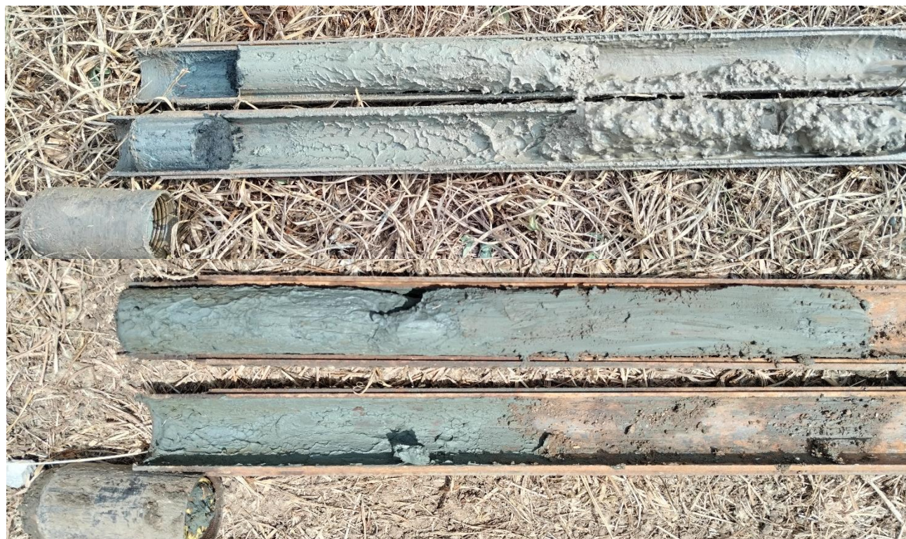
FOTO No 7: MUESTRAS DE ARCILLA DE ALTA PLASTICIDAD EXTRAÍDAS DE LOS HOYOS, A LA PROFUNDIDAD DE 3.00 A 6.00 M.
