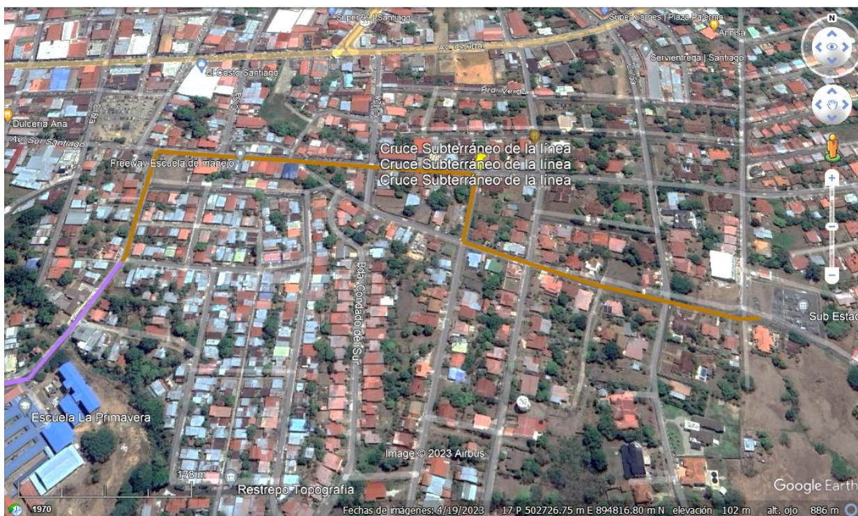
Imagen No. 2 Recorrido de la Línea de Media Tensión, cruce subterráneo.
