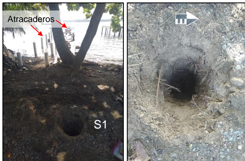
Figura 5. Sondeo 1 al borde del mar y postes de un atracadero no terminado.
