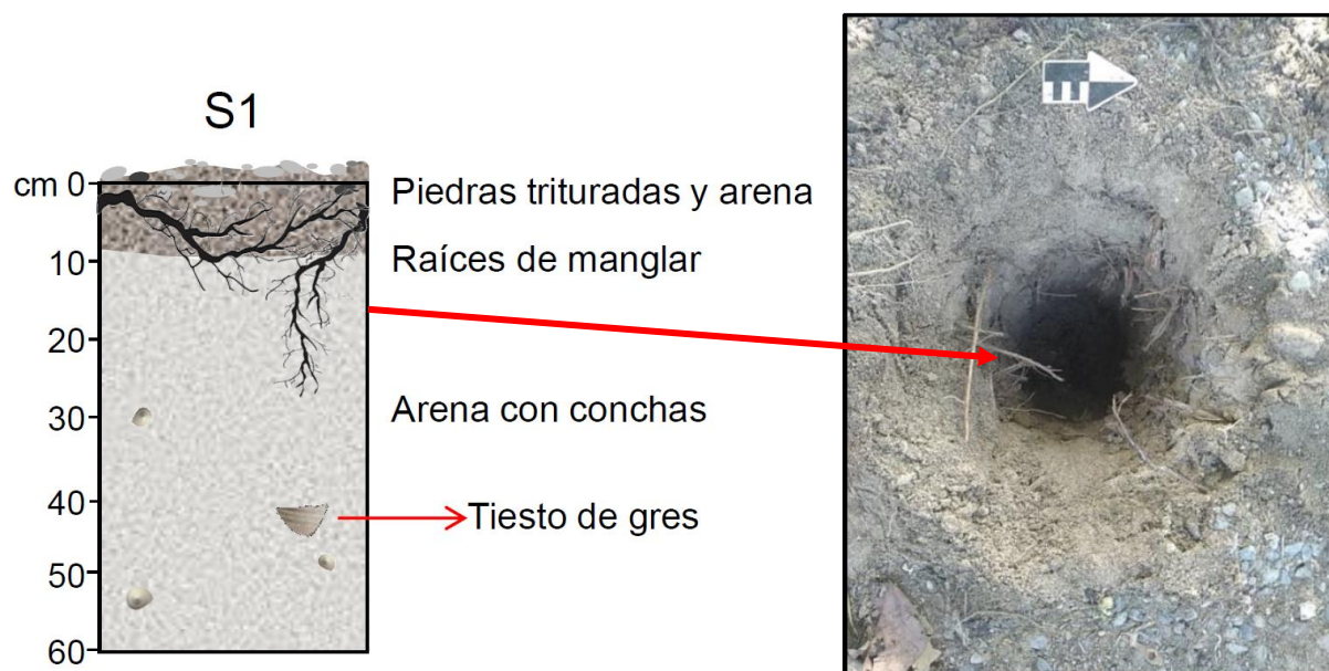
Figura 5.3.1. Sondeo realizado en el área del proyecto (zona de amortiguamiento), y que evidencia la presencia de grava y arena mezcladas en un espeso sistema de raíces de las palmeras circundantes en los primeros 10 cm de profundidad, y arenas grises más homogéneas con fragmentos de conchas y basura intermitente en los 50 cm subyacentes, sin evidencia del nivel freático en los sesenta centímetros de profundidad. Fuente: Datos de campo: Dr. D. Cáceres y Dr. G. Pearson. Isla Carenero. Proyecto ATRACADERO Y CASA DE BOTES. Sep., 2023.
