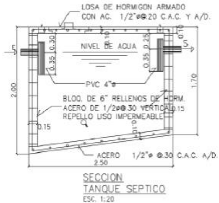
DETALLE DE TANQUE SEPTICO.
